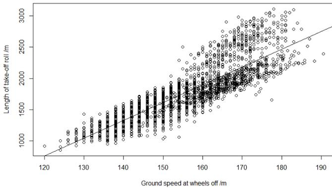
FIGURE VI - SCATTER PLOT OF LENGTH OF GROUND SPEED AT WHEELS OFF AGAINST LENGTH OF TAKE-OFF ROLL
