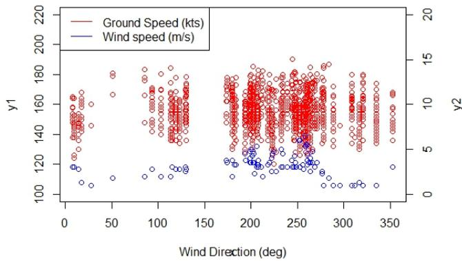
FIGURE VIII – GROUND SPEED AT WHEELS OFF (y1) AND WIND SPEED (y2) AGAINST WIND DIRECTION
